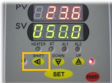
[PV：目前恆溫槽溫度/SV：設定的溫度]
