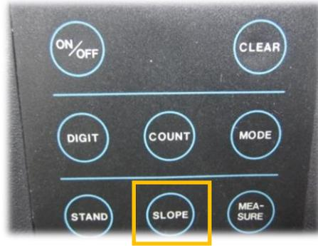
4. 取出電極、以 DI 水沖洗乾淨、以拭鏡紙按壓式擦乾，將電極浸入待測液中，按 **MEASURE** 進行測量，等待 WAIT 燈消失(儀器發出嗶一聲)，此時螢幕顯示之數字即為待測液之 pH 值。
